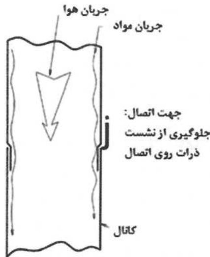
شکل (۱۴-۵-۲): هم‌پوشانی اتصالات کانال تخلیه هوا
