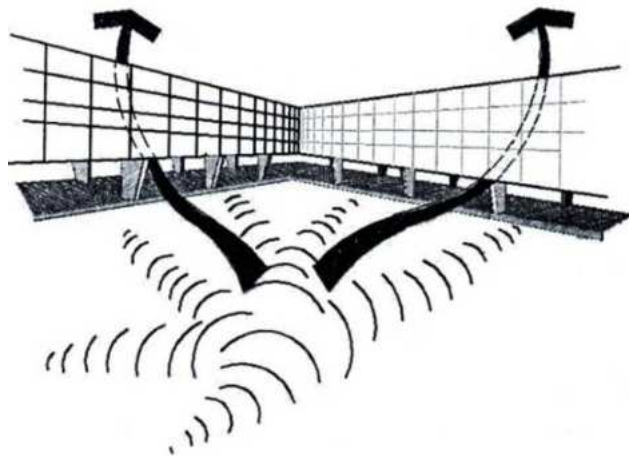
شکل ۲-۲۱-۵- تخلیه موج انفجار از پیلوت باز
